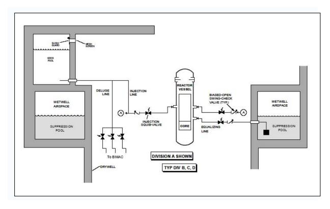
Figure 23. Gravity-Driven Cooling System
